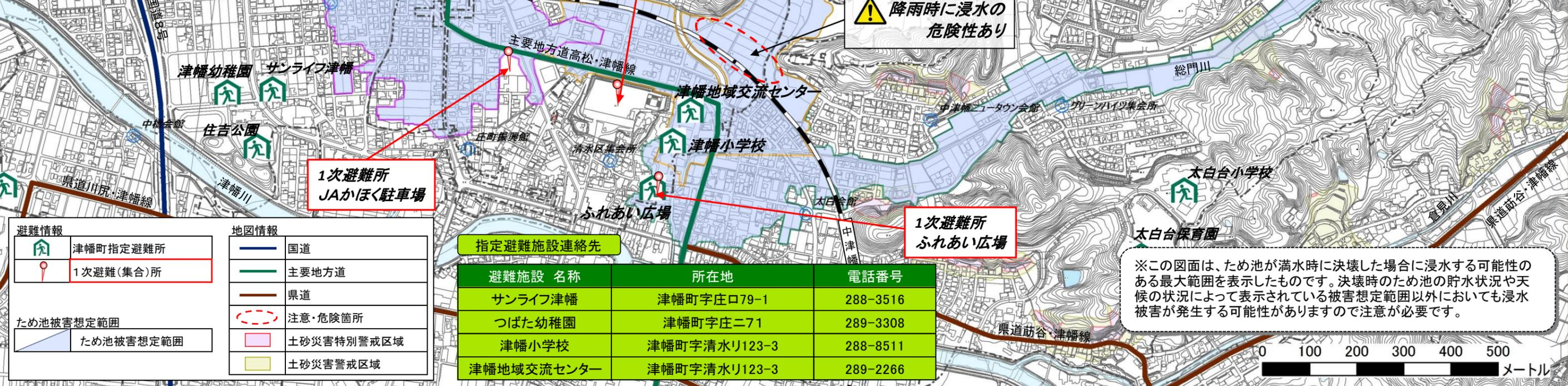
※この図面は、ため池が満水時に決壊した場合に浸水する可能性のある最大範囲を表示したものです。決壊時のため池の貯水状況や天候の状況によって表示されている被害想定範囲以外においても浸水被害が発生する可能性がありますので注意が必要です。
